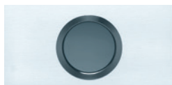
Edelstahl-gerahmtes Bullauge, mit 31 mm- Acryl-Dreifachverglasung Abmessungen: Innen: ca. \varnothing 290 mm Außen: ca. \varnothing 350 mm
